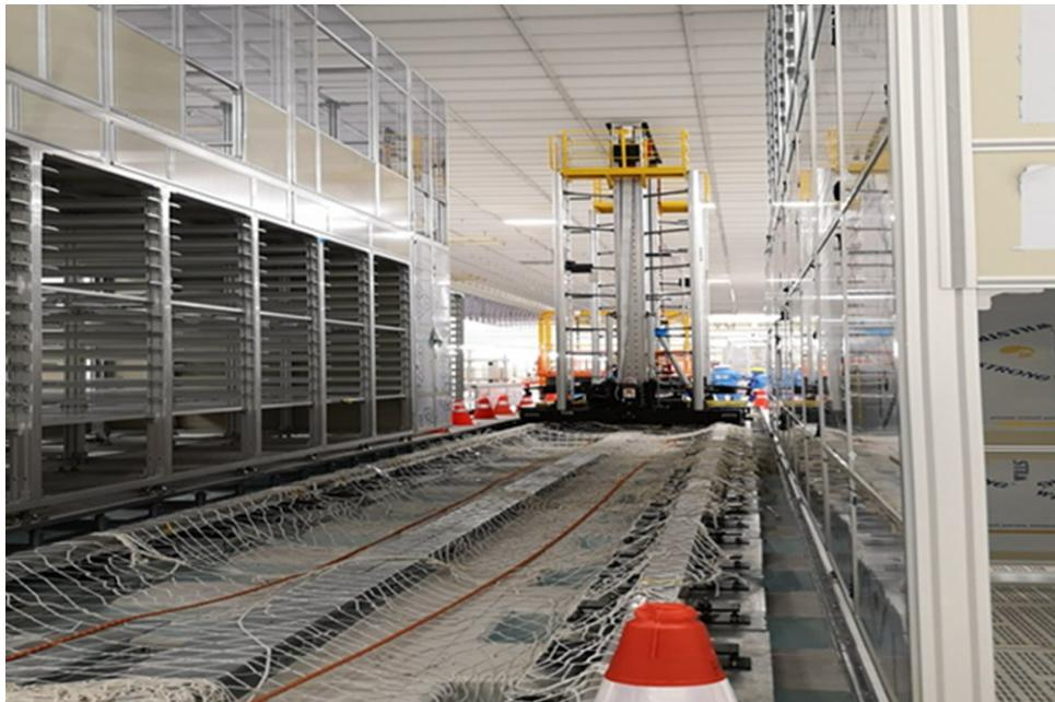
堆垛机采用编码器认址时，通过相应的安装方式，将堆垛机距离值通过编码器转化为脉冲数值，该数值通过PLC的高速计数端子进入PLC从而实现认址。采用编码器认址往往会制约堆垛机的运行效率。因为编码器认址的比较大问题是走行轮在地轨上打滑而导致编码器出现计数错误，严重影响测量精度，从而降低堆垛机的可靠性。将编码器安装在被动轮上，并采用认址片加以校验，会改善这方面的情况，但堆垛机的运行速度不能太高，一般在120m/min以下。另外，编码器定位存在累计误差，因此堆垛机每次回到原点，编码器都需要清零。编码器认址与PLC控制、矢量变频器、模拟量控制技术结合，可实现堆垛机的线性速度调节，实现平滑调速，其在中、低速堆垛机中的性能不低于激光测距，而且价格低于激光测距，使其在一定范围内仍有应用。智能仓储主要由货架系统、堆垛机系统、托盘自动化系统、输送分拣系统自动化控制系统仓库管理信息化系统。湛江立体仓库哪种好
