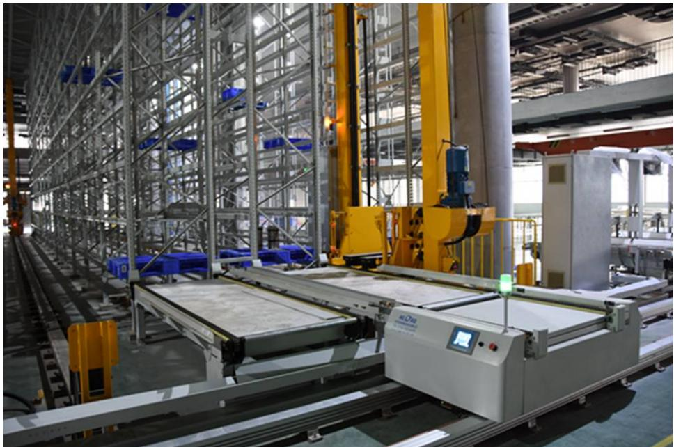
立体仓库仓储自动化分为托盘存储和箱式存储两种
